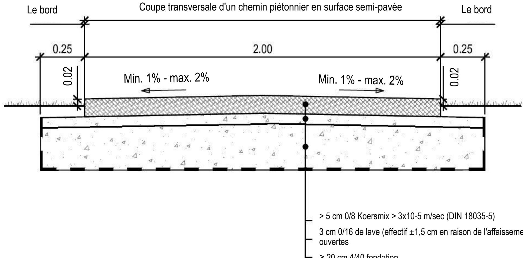
Remarque : pour les applications avec des véhicules, une pente de 3 % est recommandée.
