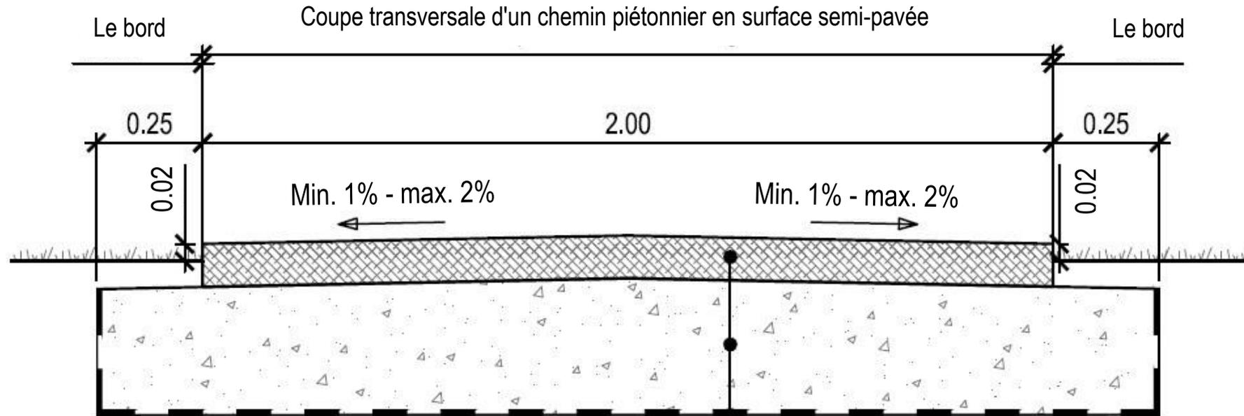
6 cm 0/8 Koersmix perméabilité  $> 3 \times 10^{-5}$  m/sec (DIN 18035-5)
